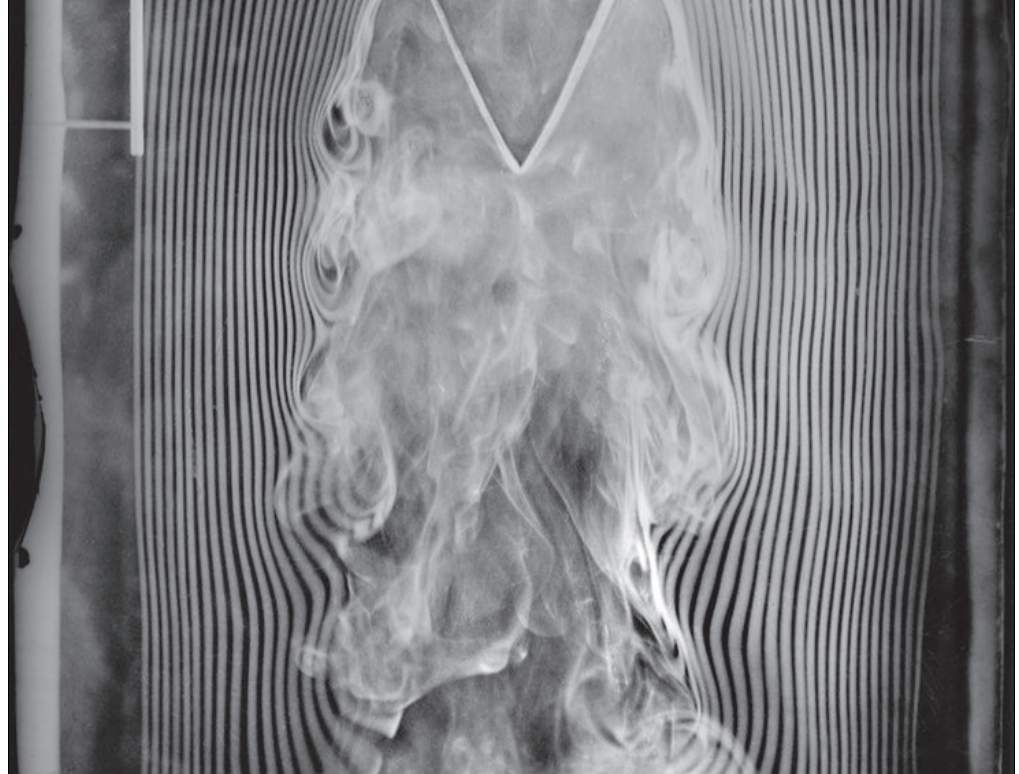
Fig. 1. — Appareil où des filets de fumée rendent visibles les mouvements de l'air.
